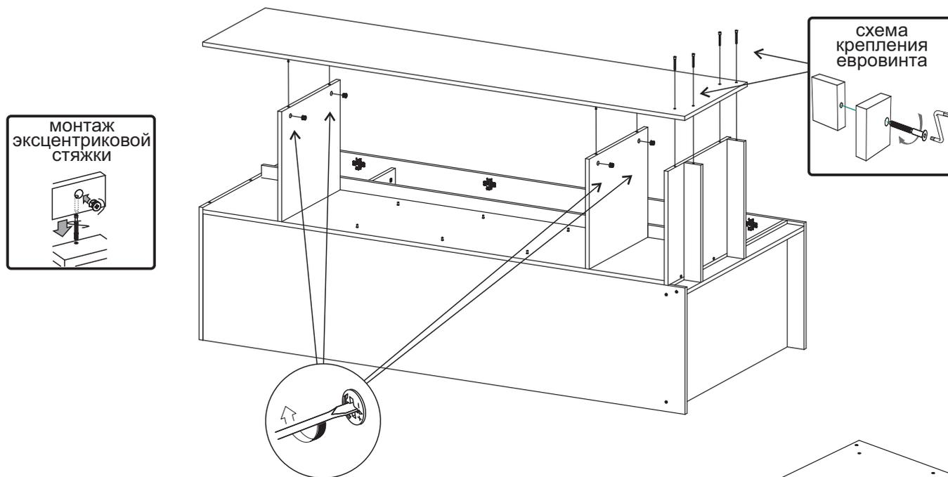
**11.** Соедините крышку №4 с боковиной №1 евровинтами, а с крышкой №5 двойными эксцентриковыми стяжками.
