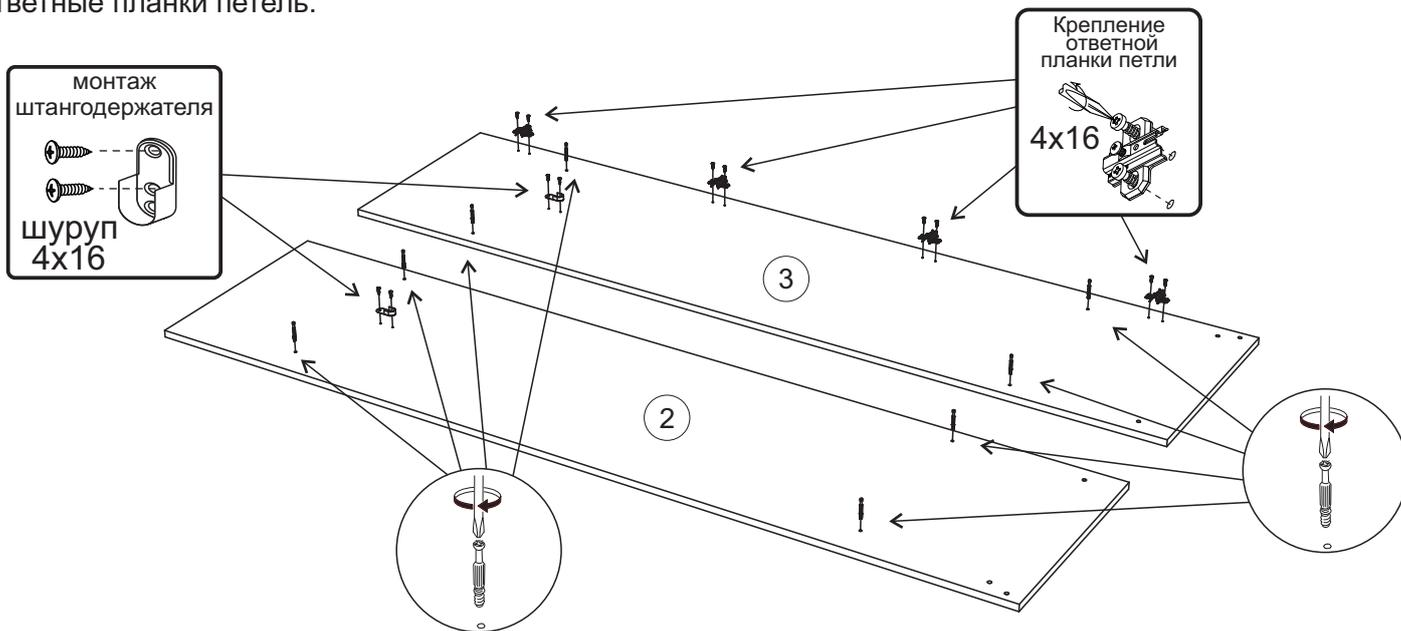
3. С помощью эксцентриковой стяжки соедините вязки №6 с боковинами №2, №3.
