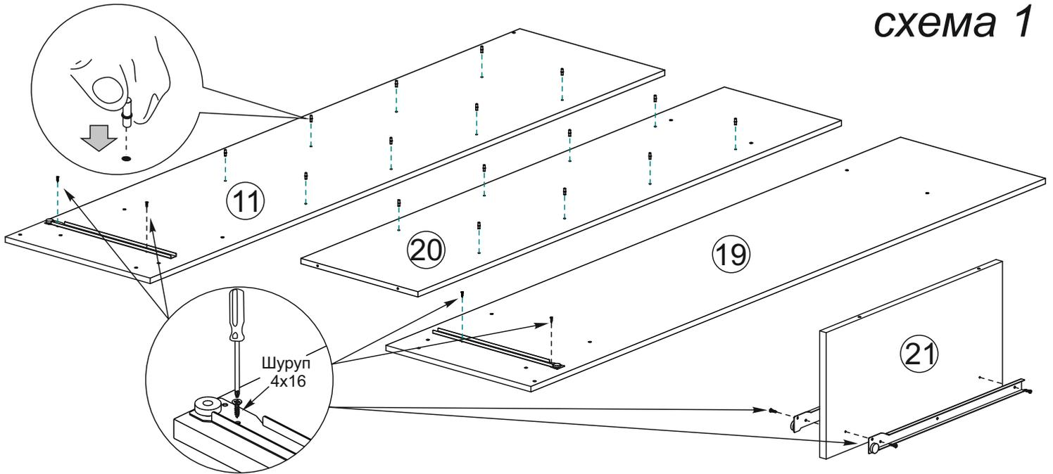
2. Сборка производится горизонтально, тыльной стороной вниз. Предварительно необходимо ориентируясь на отверстия  $\varnothing 5$  мм, установить полкодержатели на боковину №11 и перегородку №20, а также с помощью шурупов 4x16 закрепить части направляющих на боковинах №11, №19 и перегородке №21, как показано на схеме 1.
