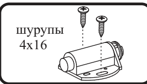
схема монтажа толкателя
