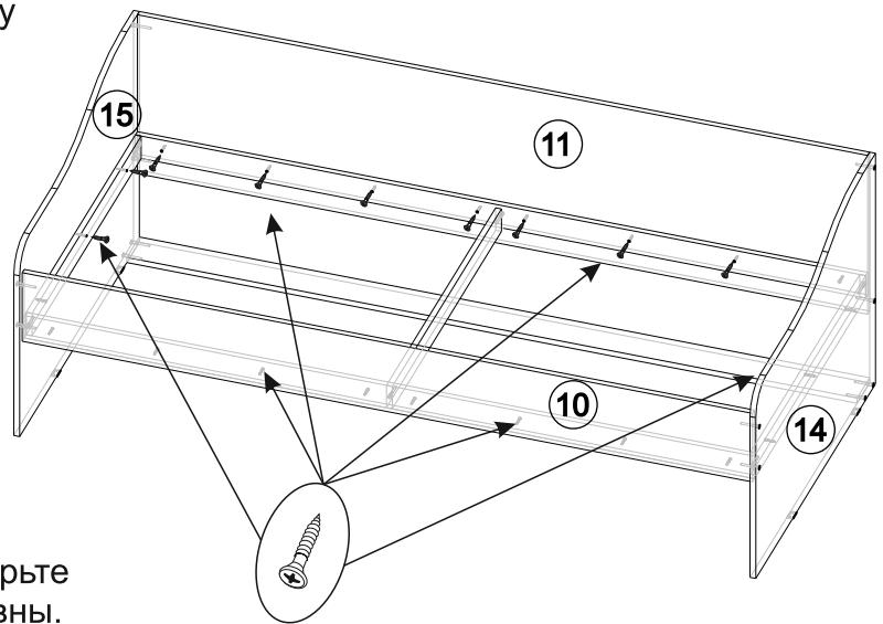
7. Переверните собранный модуль. Измерьте диагонали А и Б, они должны быть равны. Не меняя положения модуля гвоздями 2x20 прибейте два ДВП -19 к планкам внутреннего каркаса.
