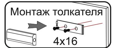
**Схема установки и регулировки толкателя!**
