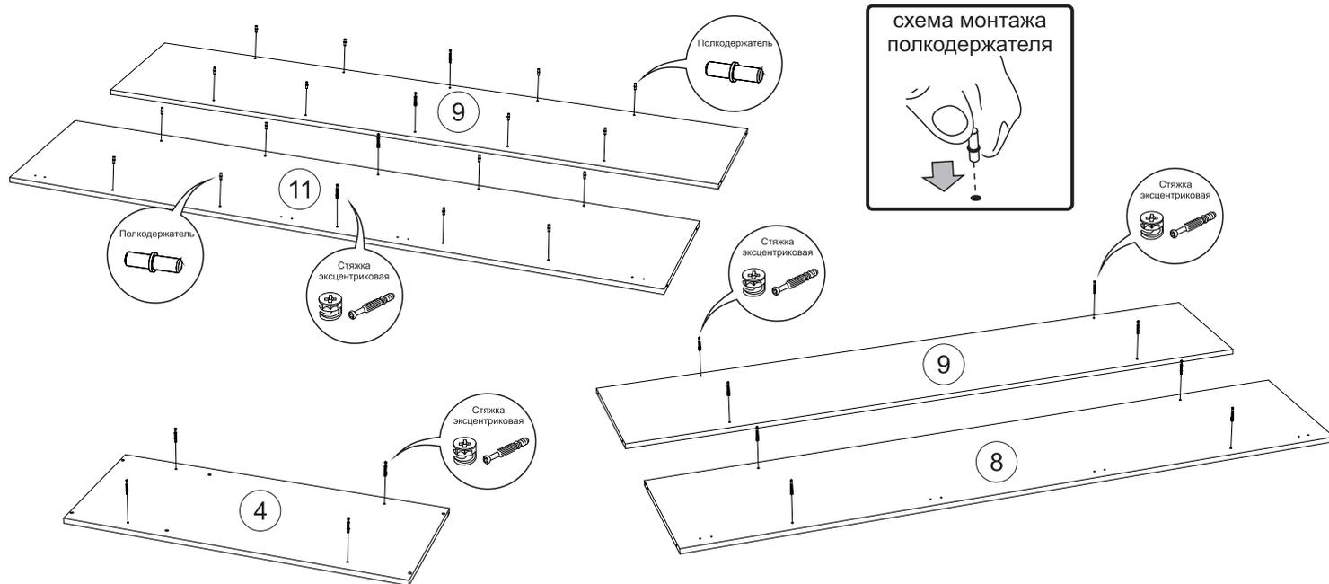
3. На крышку 4 установить штоки эксцентриковых стяжек.
