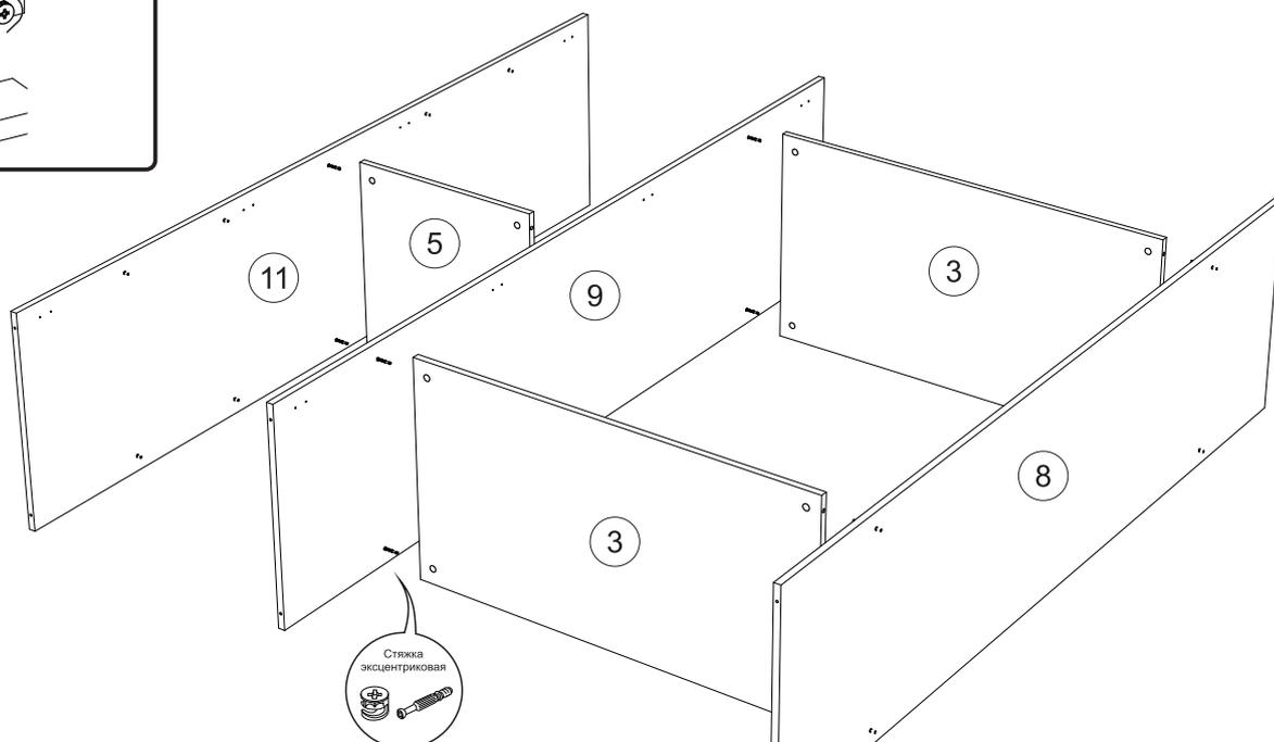
4. Соединить боковины 8, 11 и перегородку 9 вязками 5 и 3 эксцентриковыми стяжками, как показано на схеме.
