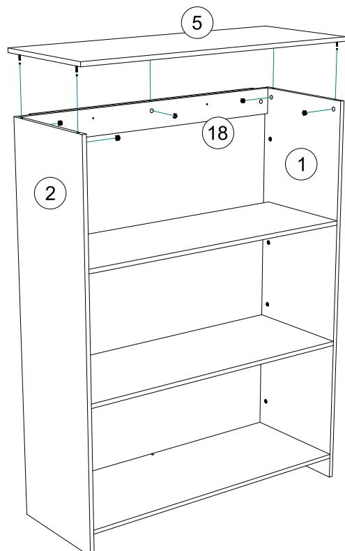
5. В крышку №5 вкрутите штоки эксцентриковых стяжек, затем соедините крышку с боковинами №1, №2 и задней стенкой №18.
