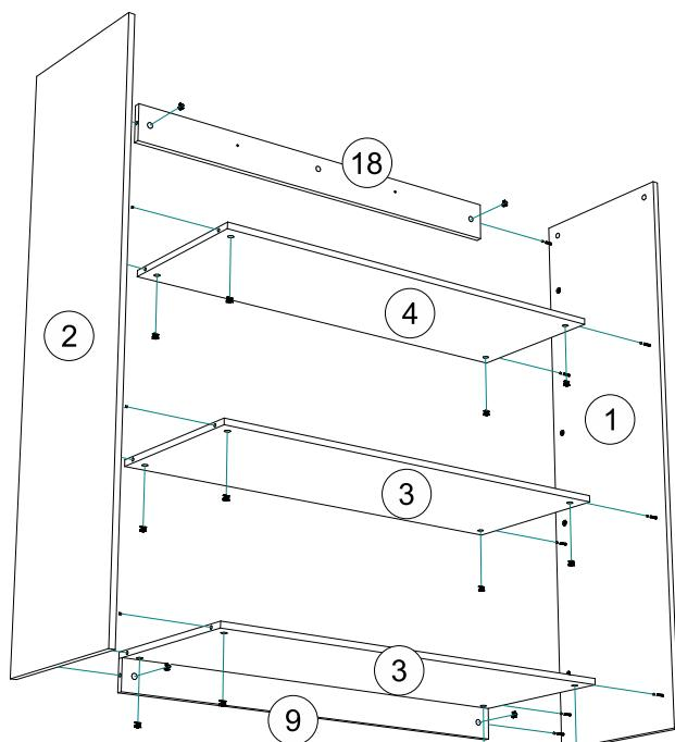
4. С помощью эксцентриковых стяжек соедините боковины №1, №2 с вязками №3, №4, цоколем №9, задней стенкой №18.
