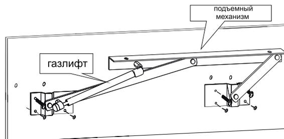
6. Установите ортопедическое основание на подъемный механизм и отрегулируйте его.
