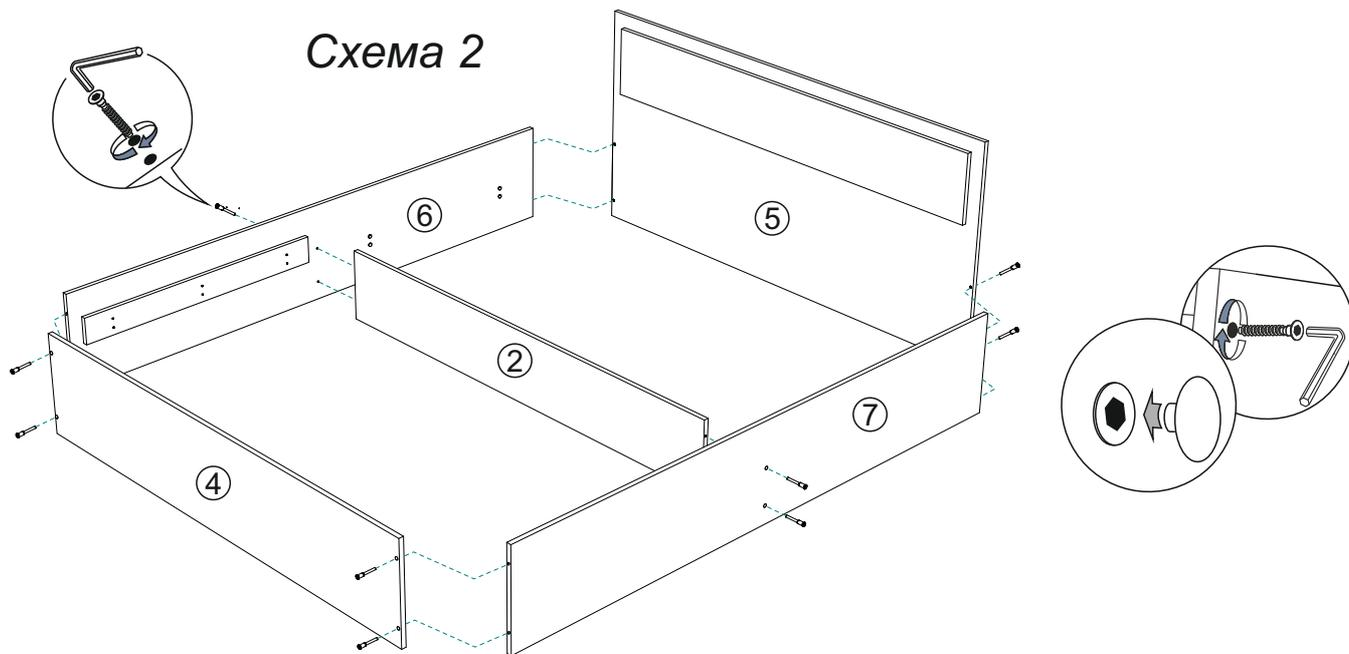
4. Для усиления жесткости конструкции соедините щитки №5 и №6 и царги №6 и №7 уголками 70x70x55 при помощи шурупов 4x16. Затем прибейте гвоздями дно №8, предварительно соединив его при помощи соединительного бруса №9. После этого прибейте подпятники гвоздями, как показано на схеме 3.
