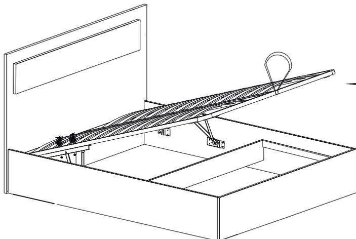
Соединить концы ленты (можно сшить или завязать узлом), продеть один конец петли под раму ортопедического основания, вставить в другой конец петли и затянуть узел.
