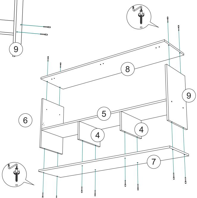
**4. Для закрепления задних стенок №2, №3 положите изделие горизонтально, лицевой стороной вниз. Далее следует выровнять диагональ при помощи рулетки, после чего закрепить задние стенки гвоздями.**
