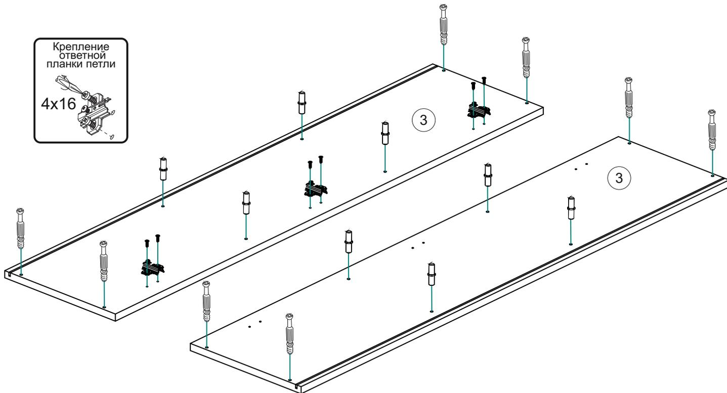
3. С помощью эксцентриковых стяжек соедините боковину №3 с вязками №4. Затем вставьте заднюю стенку №1 в пазы боковины и вязок. После соедините оставшуюся боковину с вязками №4.
