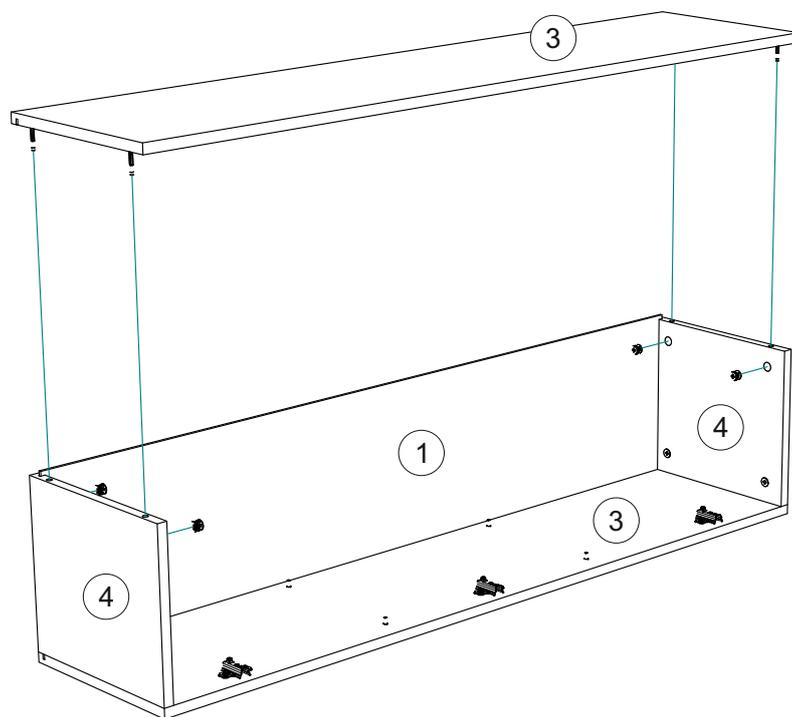
4. Используя соединители RV-8 и шурупы 4x16 закрепите заднюю стенку №1.
