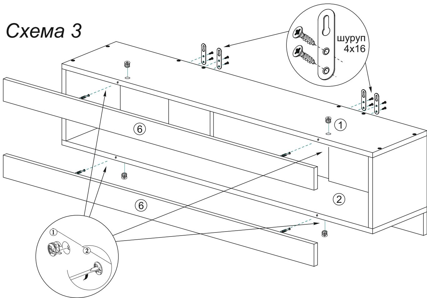
5. Кроме того полку можно закрепить к соседним модулям при помощи межсекционных стяжек. Для этого надо досверлить отверстия Ф5 на боковинах и в боках соседних модулей и стянуть их межсекционной стяжкой из набора фурнитуры.
