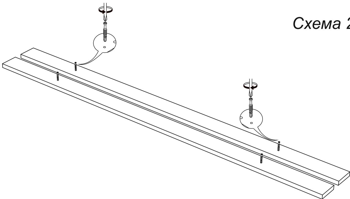
4. Планки МДФ №6 закрепите на вязках №1 и №2 с помощью эксцентриковых стяжек. На задние стенки №4 закрепите навесы плоские шурупами 4x16, как показано на схеме 3.
