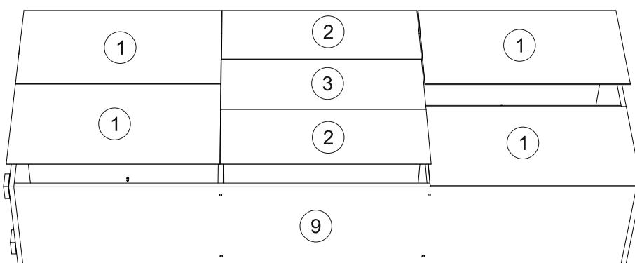
**7)** Для закрепления задней стенки изделие необходимо положить на ровную поверхность тыльной стороной вниз, после чего закрепить панели 1,2 и 3 гвоздями, предварительно выровняв диагональ при помощи рулетки. Для крепления в местах стыковки панелей рекомендуется использовать пластиковые шайбы.
