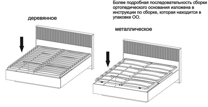
**19**. Для кроватей с подъемным механизмом, крепление последнего осуществляется с помощью болтов 6х25, шайб D6, гаек M6.
