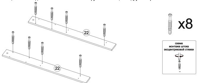
12. \* В фасад накладку №12 вставьте эксцентрики (бочонки) с обеих сторон, после соедините его эксцентриковыми стяжками с боковиной №22. Далее эксцентриковыми стяжками соедините щит головной №20 с боковиной №22.
