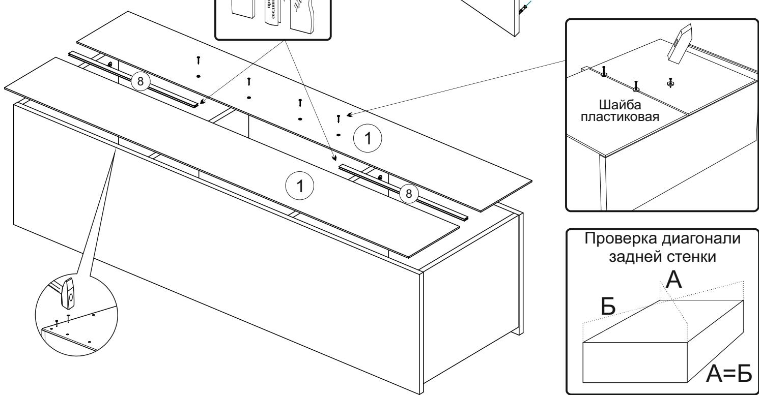
6. Шурупами 4x16 закрепите уголки для крепления к стене в наиболее удобных Вам местах и прикрепите антресоль к стене (фурнитура для крепления к стене не входит в комплектацию изделия!).
