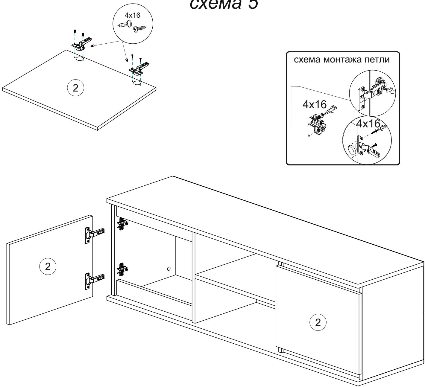
Регулирование зазоров и положения дверей с петлями
